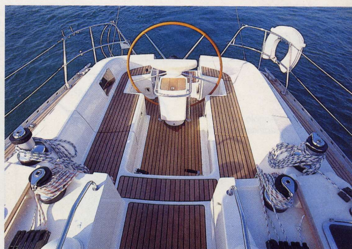
Il pozzetto del Sun Odyssey 42.1 misura cm 255x193 ed è uno dei più grandi della categoria. La consolle della ruota ingloba la strumentazione elettronica e una ghiacciaia utilizzabile anche come vano stagno.
