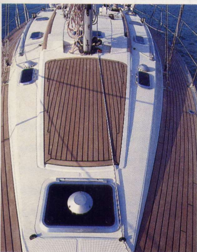
Questo ampio prendisole, completamente sgombro, misura cm 100x180. Il rivestimento in teak è opzionale.
