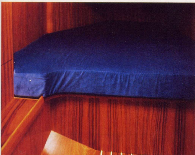
Una delle due cabine gemelle di poppa. La cuccetta misura cm 136 x 200, l'aerazione è ottenuta da due oblò apribili e un boccaporto sulla tuga. Due i vani per il vestiario.
