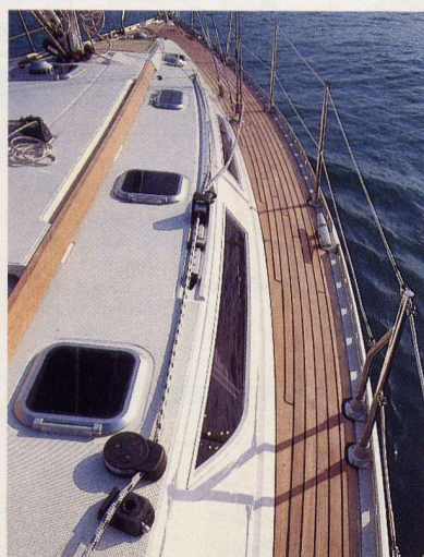
La rotaia del genoa e il relativo rinio sono posti sulla tuga, dove si possono anche notare i numerosi boccaporti.
