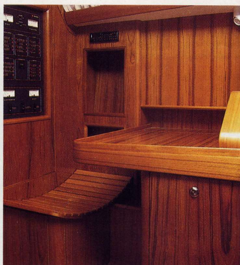
Il piano del carteggio misura cm 65x80. Il mobile verticale contiene una spaziosa cambusa a cassetti.
